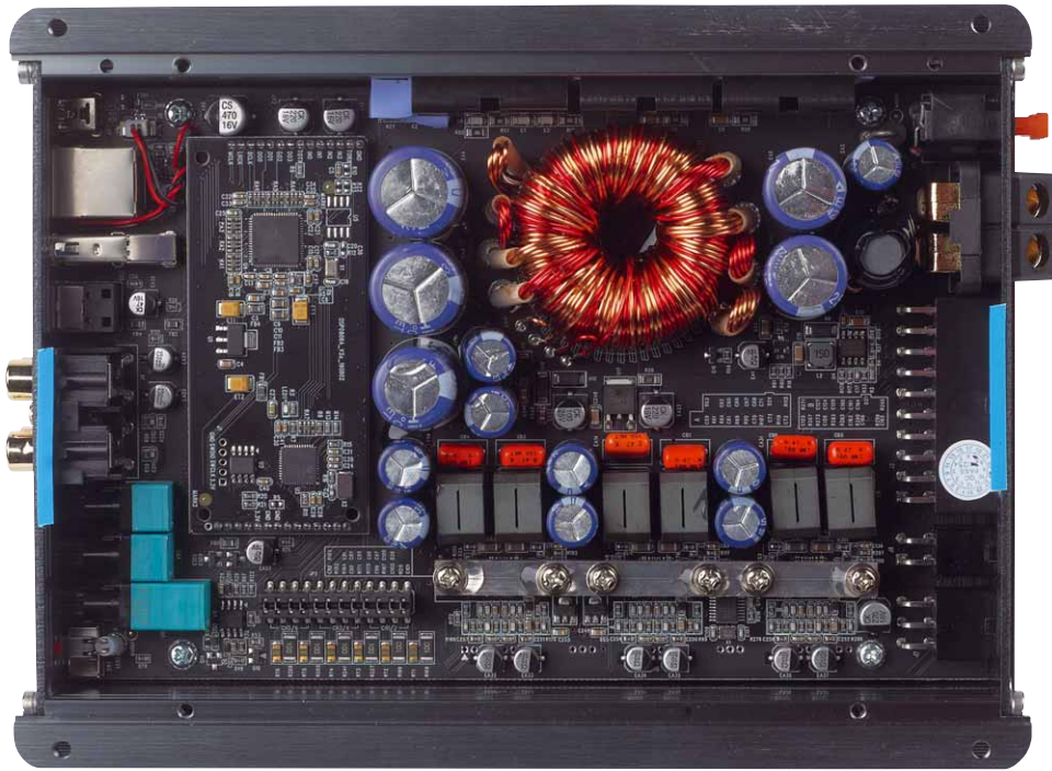
Links auf der Tochterplatine DSP untergebracht. Unten sitzt der Jumper für die High/Low Umschaltung
