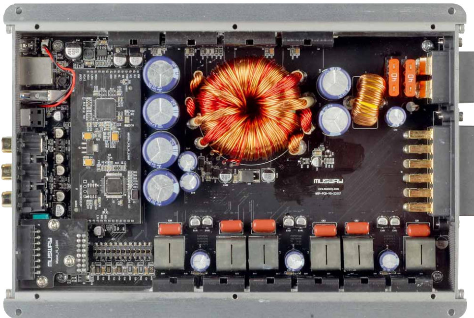
Das massive Trafonetzteil versorgt 6 gleiche Kanäle, die über MOSFETs befeuern
