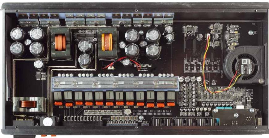
Sauberer Aufbau mit äußerst kräftigen Doppelnetzteil mit Flachdrahtspulen und einer 12er-Reihe Tiefpassspulen unter dem schmalen Kühlkörper für die 6 Verstärker-ICs
