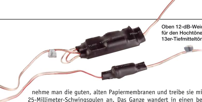
Oben 12-dB-Weiche mit Pegelabsenkung für den Hochtöner, unten 6-dB-Spule für den 13er-Tiefmitteltöner
