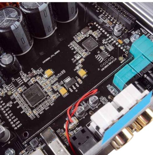
Auf der Tochterplatine befindet sich der neue DSP mit dem ADAU1452 von Analog Devices
