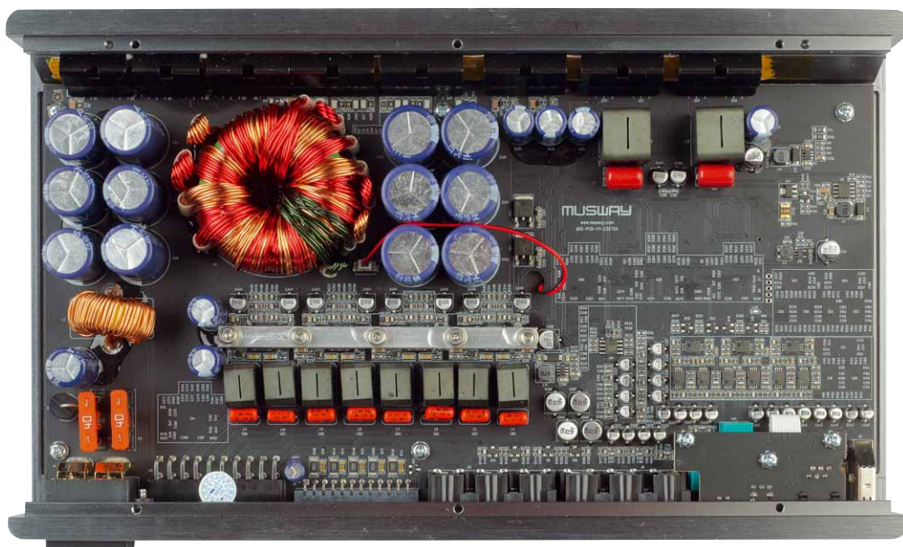
Die 8 kleinen Kanäle sitzen unter der mächtigen Spannungsversorgung mit XXL Trafo, die größeren Spulen oben rechts gehören den großen Kanälen
