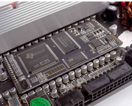
Auf der DSP-Platine finden sich der große TI-DSP, der Controller und zwei Speicherbausteine
